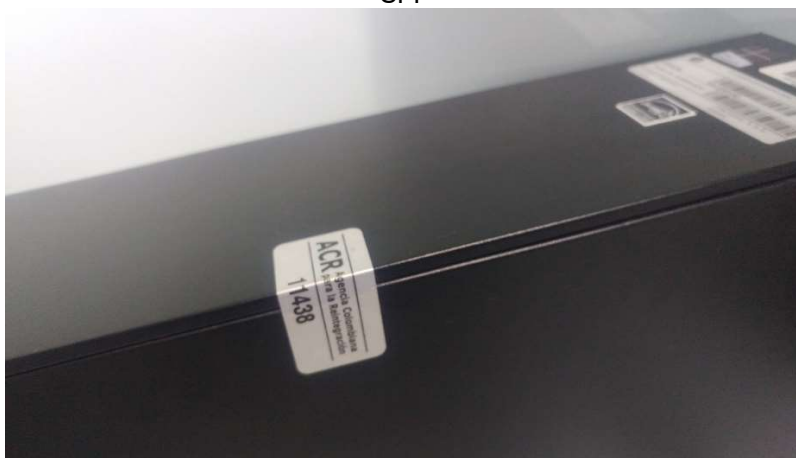
Figura 1. Ejemplo de sello fijado en tapa de acceso a la torre de un PC HP-COMPAQ Pro 6300 SFF
